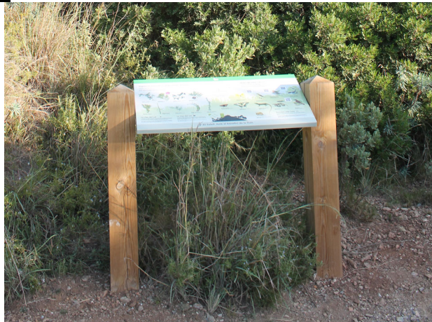
Figura 12 Plafó divulgatiu per a les zones de mirador de 120x45cm amb ala de 25mm de planxa galvanitzada pintada amb poliester amb impressió directe i vernís protector de poliester curat a 180°. Suport format per dos peus drets de fusta de pi amb tractament anticorrosiu de sals metàl·liques (basilit CFK) per immersió i autoclau sistema de buit pressió de 1500x140x140mm. Fixació al terreny amb daus de formigó de 400x400x400mm. Model del Parc de Collserola.
