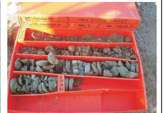
09- Testimoni del sondeig S3 de 3 a 5 m
