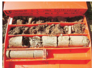
06- Testimoni del sondeig S2 de 3 a 5 m
