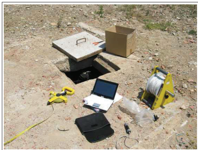
Foto 2: Mesura de nivells i descàrrega de dades al pou Distri-Vallès.
