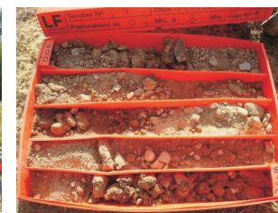
12- Testimoni del sondeig S4 de 0 a 3 m
