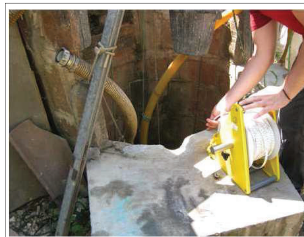
Foto 4: Mesura de nivells al pou Horta-Meandre.
