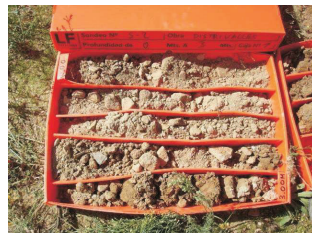
05- Testimoni del sondeig S2 de 0 a 3 m
