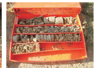
13- Testimoni del sondeig S4 de 3 a 5 m
