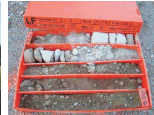
08- Testimoni del sondeig S3 de 0 a 3 m
