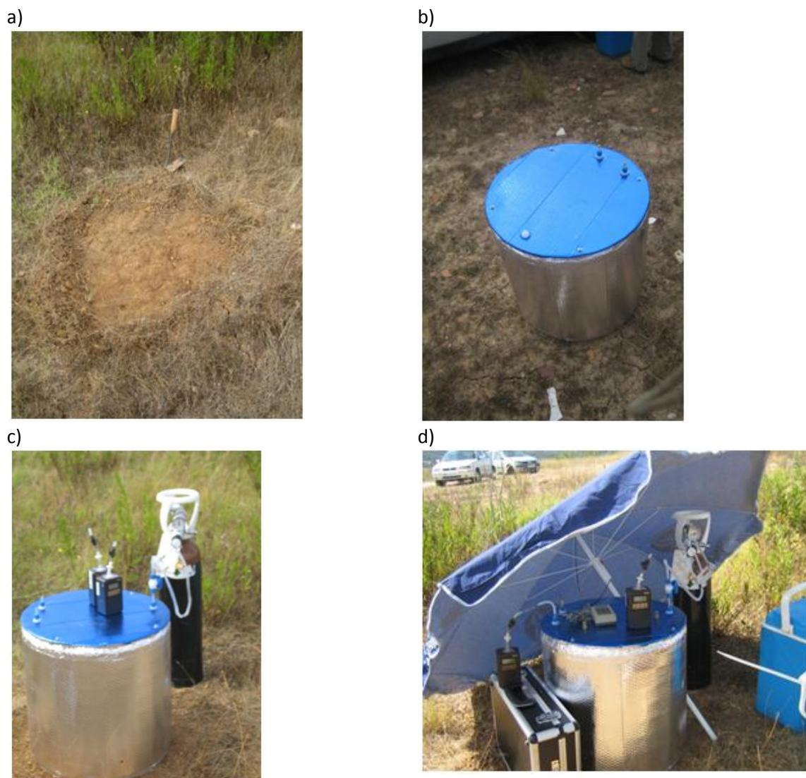
Figura 2.8. Mesura d'emissió superficial en FG-3 a) Preparació terreny, b) Campana de captura de vapors, c) Detall muntatge purga heli d) Muntatge complet per la mesura d'emissions
