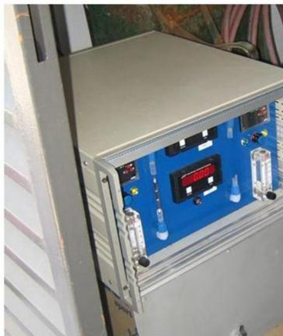
Figura 2.3. Mesura d'immissió a) Detall Captació b) Aparell de mostreig
