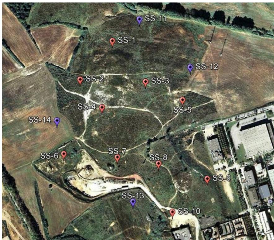
Figura 2.1. Localització dels punts de mostreig superficial. Punts vermellos: mostres dins l'abocador. Punts lila: mostres fora el perímetre de l'abocador
