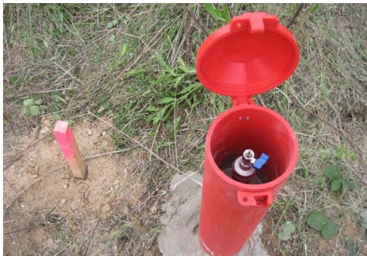
Captador de gas del subsòl SG-17 instal-lat
