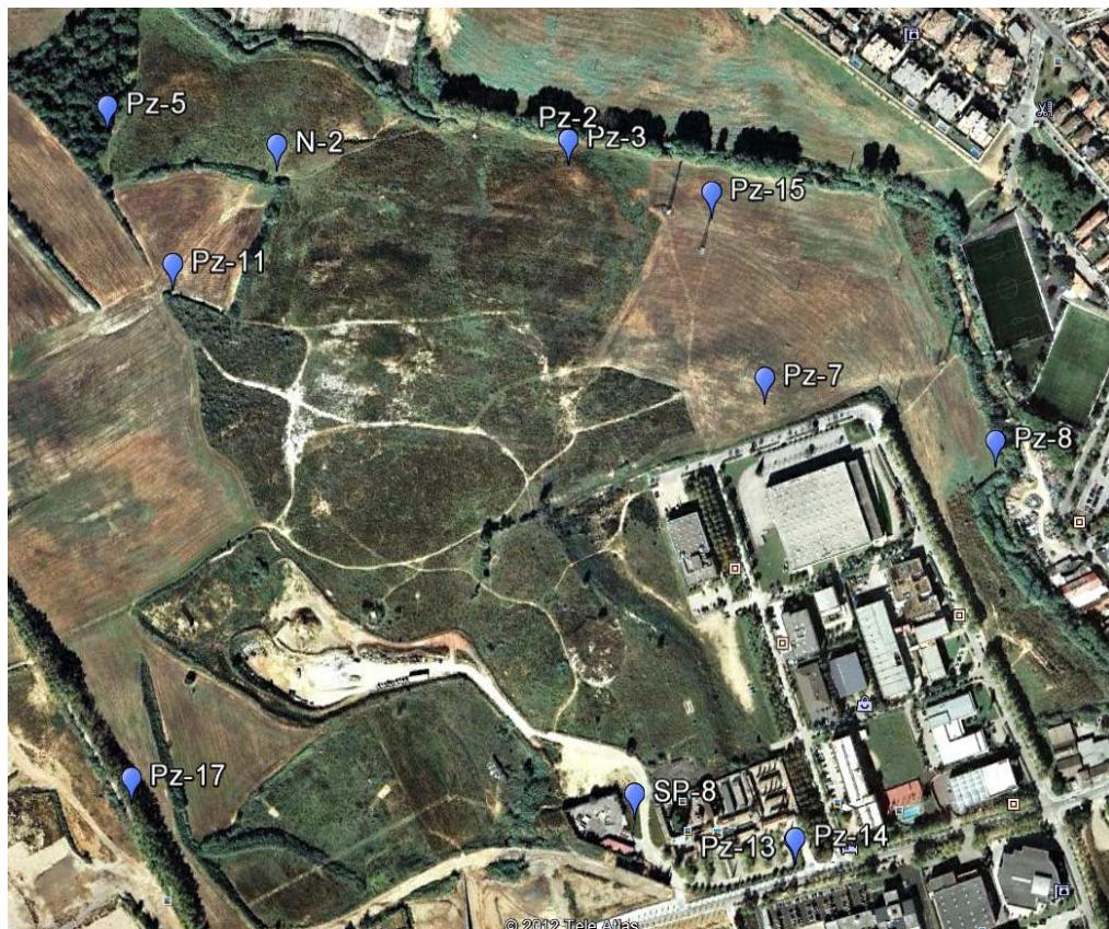
Figura 2.10. Localització dels punts de mostreig d'aigua subterrània amb presència de contaminants volàtils.
