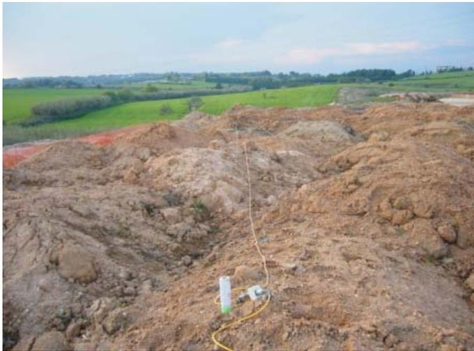
**Foto 5.-** Vista parcial del perfil de tomografía eléctrica TME-2 realizado sobre montículos de vertidos acumulados.
