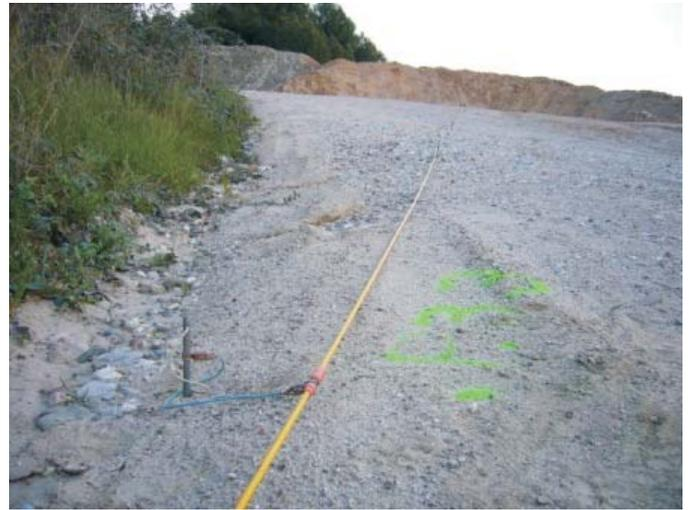
**Foto 6.-** Detalle de electrodo usado en el perfil de tomografía eléctrica TME-2 y punto de referencia topográfica
