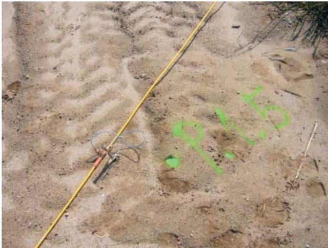
**Foto 1.-** Detalle de uno de los puntos de referencia topográfica marcados en la campaña de campo.
